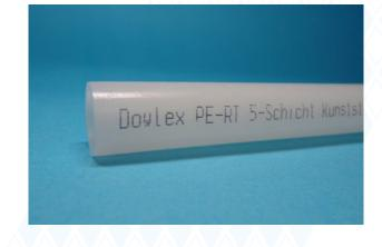
Durch das spezielle Fertigungsverfahren wird aus dem speziell modifizierten Polyethylen (Kurzzeichen PE) mittels eines Extrusionsverfahren das Bavaria-PE-RT-Rohr in einem Arbeitsgang als 5-Schicht-Rohr produziert. Die Evoh-Schicht sorgt für eine sehr gute Sauerstoffbarrierewirkung. Das Kunststoffrohr wird durch die äußere PE-RT-Schicht vor Beschädigungen von außen geschützt.
